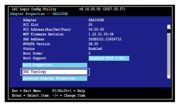
Press <Alt+D> to display device properties, or <Alt+M> to display more keys.
